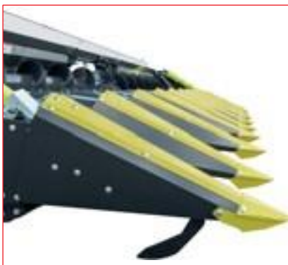
Szenzorkészlet a talajkövető automatikához
